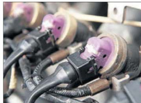
Moderne gasinjectoren zorgen voor de toevoer van brandstof. In Lapland zal Ilya vanwege de kou echter op benzine rijden.
